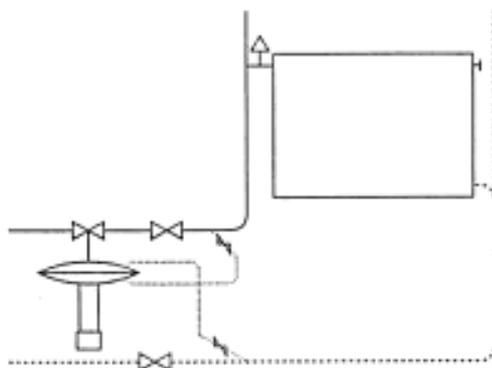
Регулятор перепада давления с регулирующим клапаном можно устанавливать на трубопровод в любом удобном для монтажа положении, но с обязательным соблюдением направления потока среды через клапан (согласно стрелке на корпусе).
